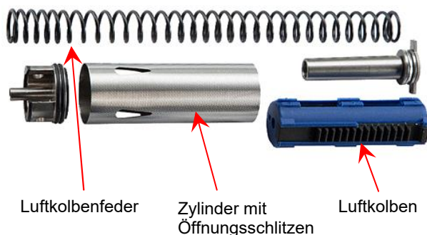
Bild 9: Einzelteile eines Kolbensystems
